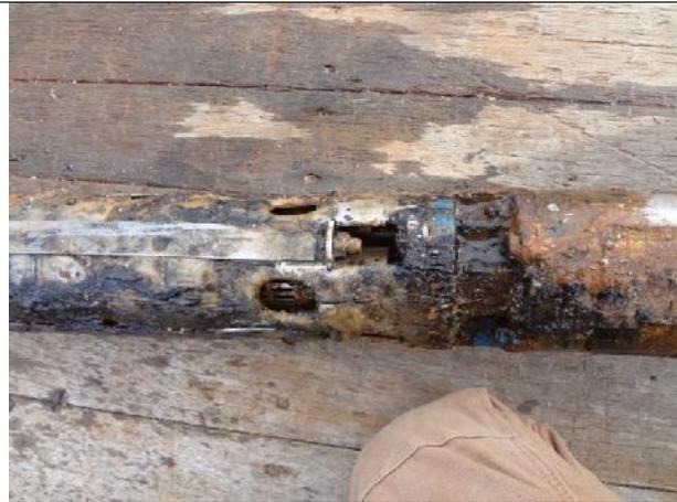
Sulfur-oxidizing dominant biofouling (Ohio USA, sandstone aquifer)
